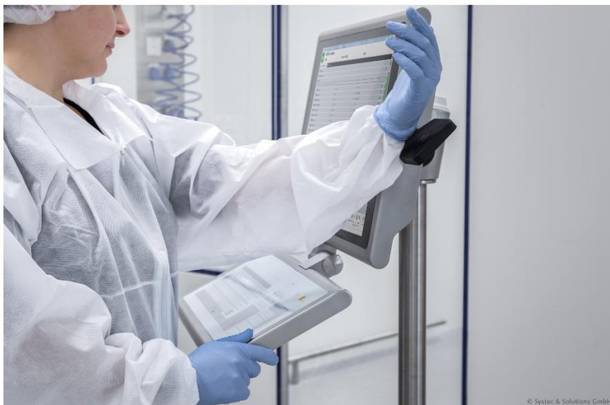
Das Nymi-Band ermöglicht es Bedienern, sich durch biometrische Merkmale sicher und einfach bei Werum's PAS-X MES anzumelden.
